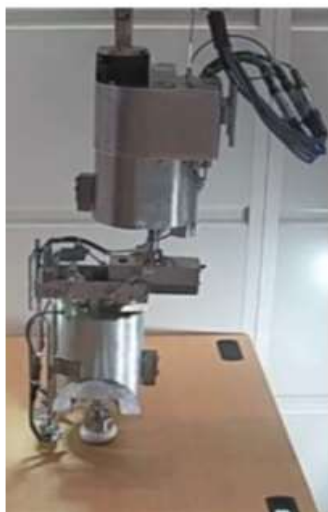
▲小石状燃料デブリ回収装置(フレキシブルグリップ型)
