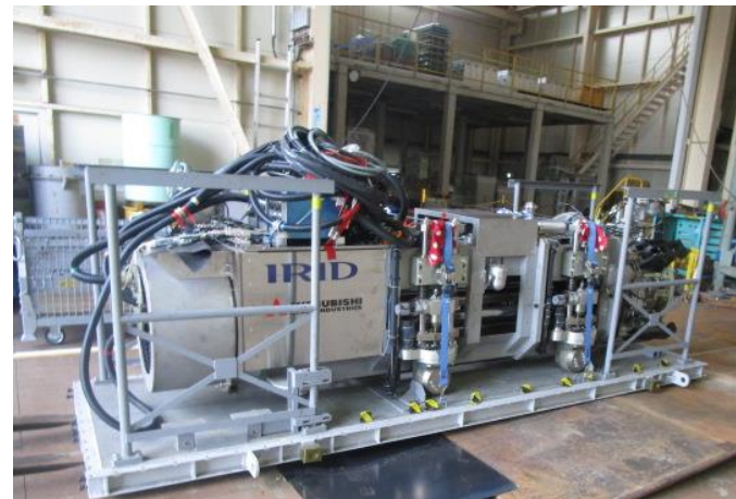
堆積物除去装置 (高圧水・AWJ) 外観
