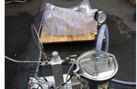
3. 水充填および水抜き試験
