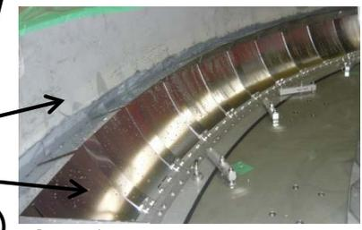
板バネによるシール (Seal by plate spring)
