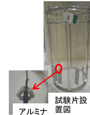
ガンマ線照射下腐食試験の状況
