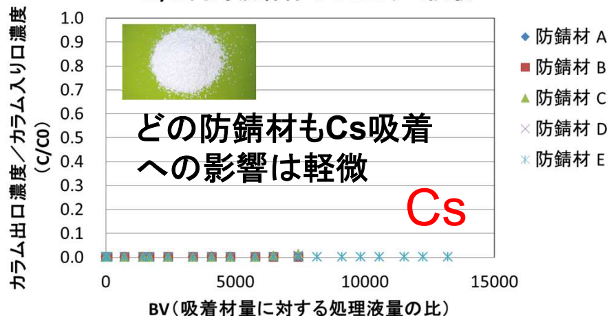
Cs/Sr同時吸着材でのCsカラム試験
