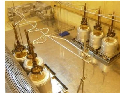
ガンマ線照射下腐食試験の状況
