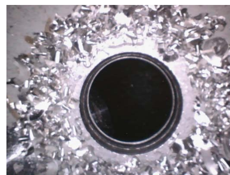
φ40 穿孔貫通後 貫通前に吸引回収を停止しているため切削片が落下 刃先が空間的に開けてることから溶接底板上に切削片が残留
