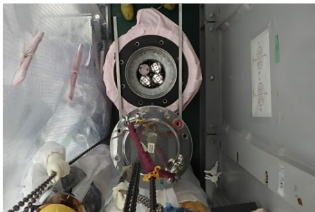
収納容器を輸送容器に格納 (WS 2階より下向きに撮影)
