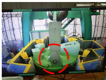
図2 吸着塔フックのかかり具合の 確認時カメラ映像
