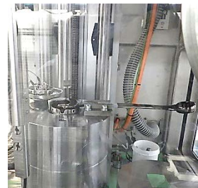
サンプリングヘッド分離 (一部人手作業)※2
