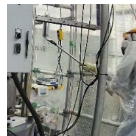
収納容器側面・底面 スミア採取
