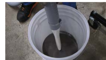
図5 鉛粒吸引回収試験
