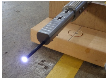
図1 内視鏡ツール プローブ部
