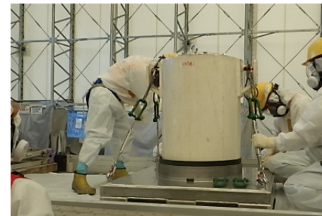
輸送容器の性状把握事業への引渡し → 高性能ALPS建屋から搬出
