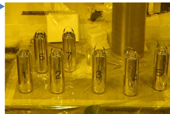
輸送容器用内容器から収納容器取出し(7検体)
