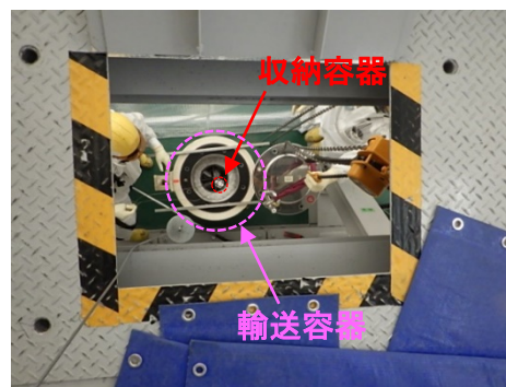
輸送容器に格納した収納容器を 仮設ハウス2階から撮影
