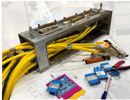
組立中の双腕マニピュレータ側端子箱
