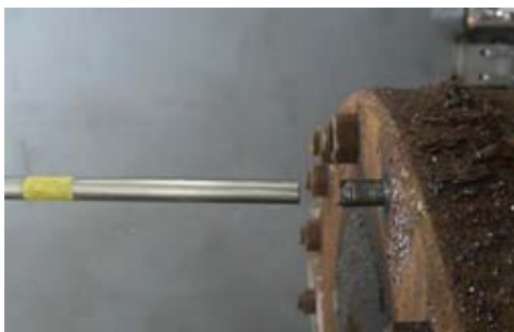
押込み棒によるボルト押込み
