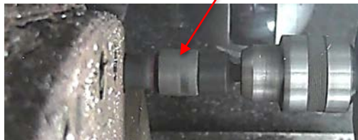
長尺ホールソーによる追加加工
