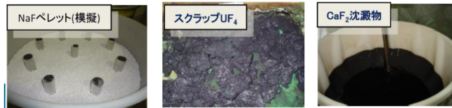
図 FNDI法の試験に用いた多様なウラン廃棄物模擬体
