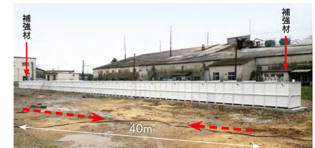
【図10-7】長距離流動試験
