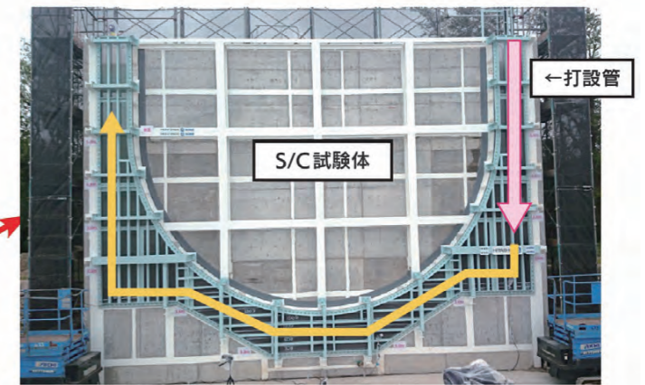
【図10-5】1/1スケールで2~3号機を模擬して実施したS/C脚部打ち上がり性状確認試験
