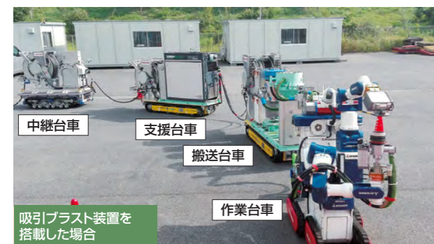
【図2-7】上部階用除染装置
