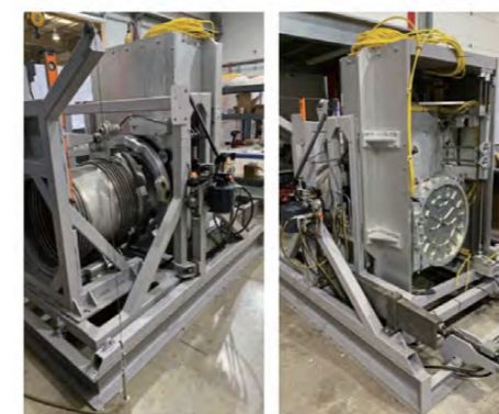
▲ダブルドアシステム 試験体
