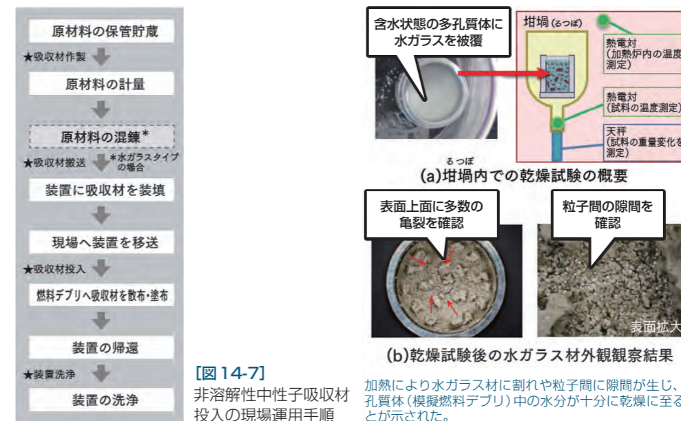
【図 14-8】 水ガラス塗布多孔質体の乾燥試験
