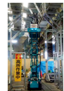
【図2-3】ドライアイスプラスト除染装置
