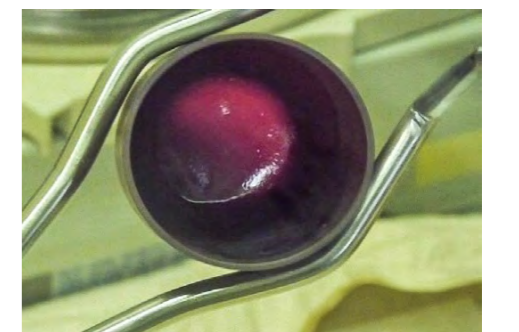
【図6-7】模擬燃料デブリのアルカリ融解試験
