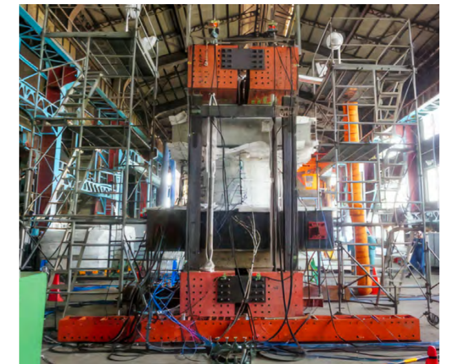
【図9-3】RPVペDESTALの耐力評価試験(縮小模型試験体)
