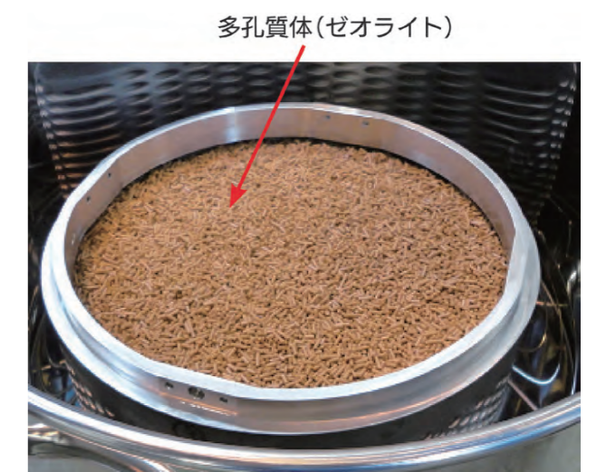
【図 15-11】乾燥試験用供試体
