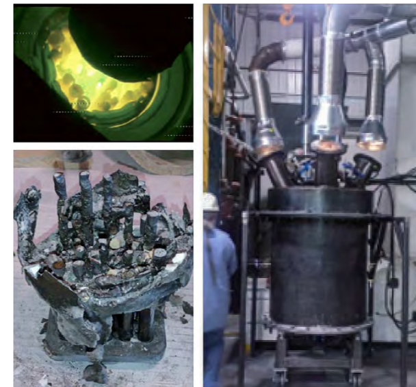
▲模擬燃料集合体 プラズマ加熱試験 (加熱状況・試験後の試験体)
