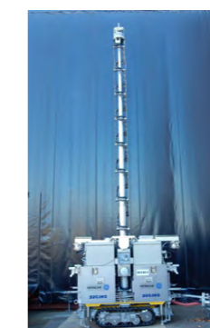
【図2-2】高圧水ジェット除染装置
