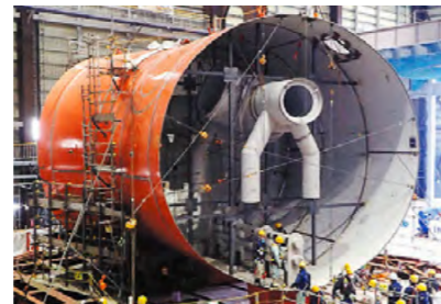
【図10-2】 S/Cシェルと ダウンカメラ組み立て
