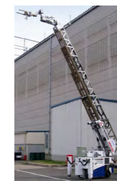
【図2-1】吸引・プラスト除染装置
