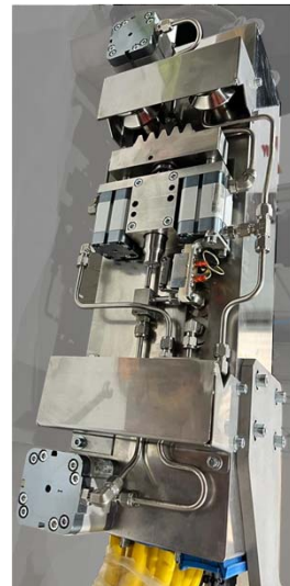
エンクロージャ側端子箱背面
