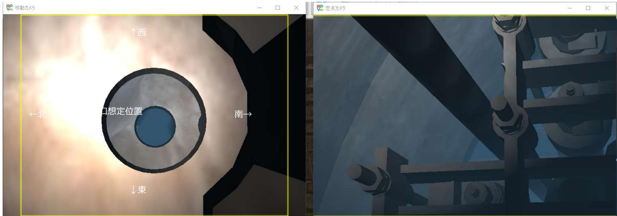
2号機 テレスコ収縮状態から3000mm伸展時のカメラ映像(西側に2°傾き)
