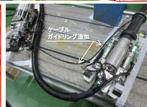
有線用ロッド先端のケーブル送り機構外観 事前動作確認時のガイドリングの追加
