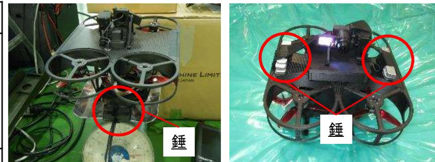
ドローンへの錘の搭載状況(左:有線、右:無線)
