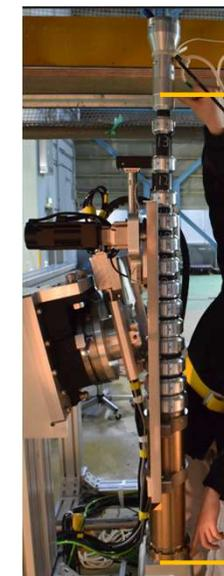
この範囲の長さを測定して飛び出し量が170mmであることを確認
