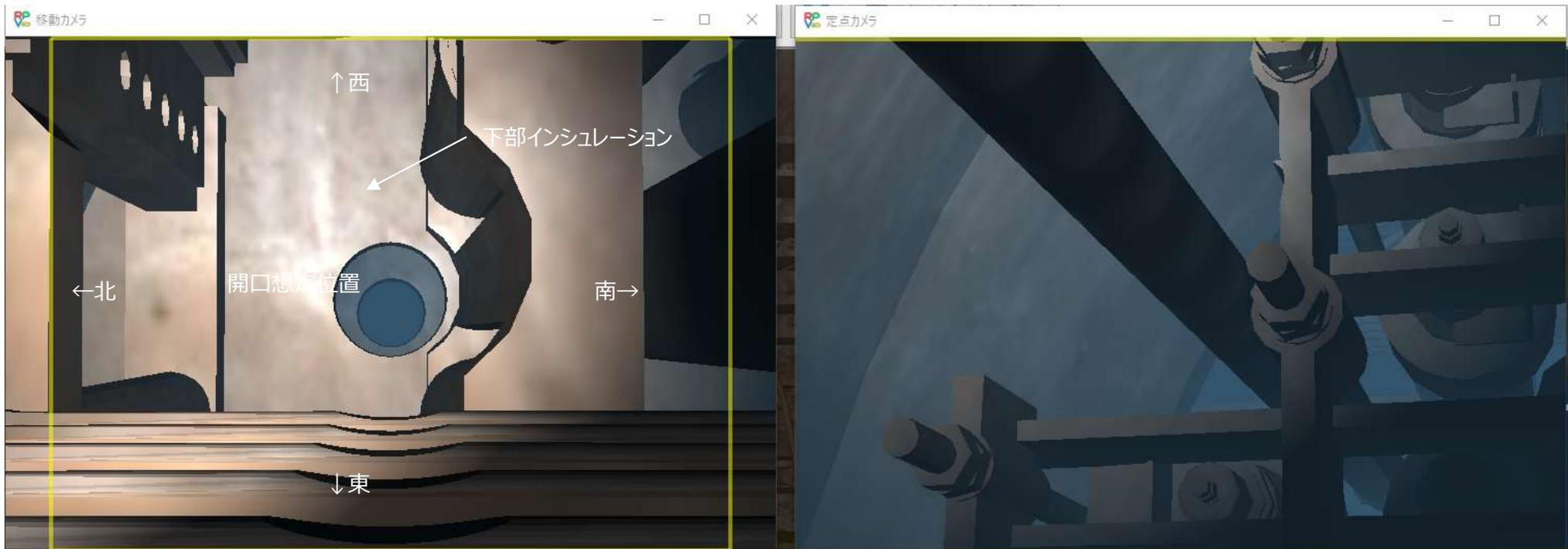
2号機 テレスコ収縮状態から2000mm伸展時のカメラ映像(西側に2°傾き)
