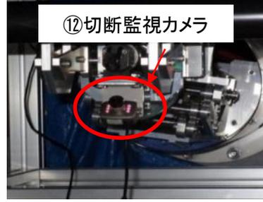
図92 対象機器(手摺切断装置)
