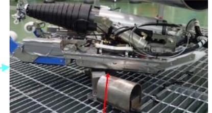
後方クローラはフラット形状で残置B1調査装置に引掛り易くしている
