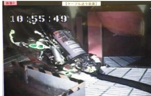
前方クローラベルト形状をブロック千鳥状に変更することで、斜め方向での牽引力が向上(150→320N)
