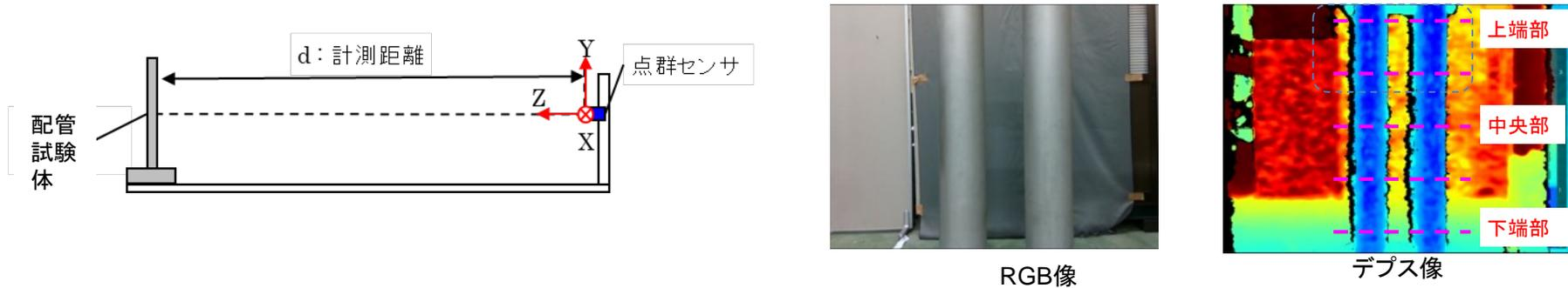
図32 点群データ採取概要(配管間隔)
