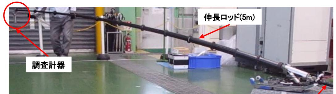
図17 ペDESTAL内調査装置
