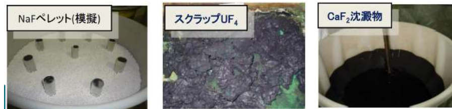
図 FNDI法の試験に用いた多様なウラン廃棄物模擬体
