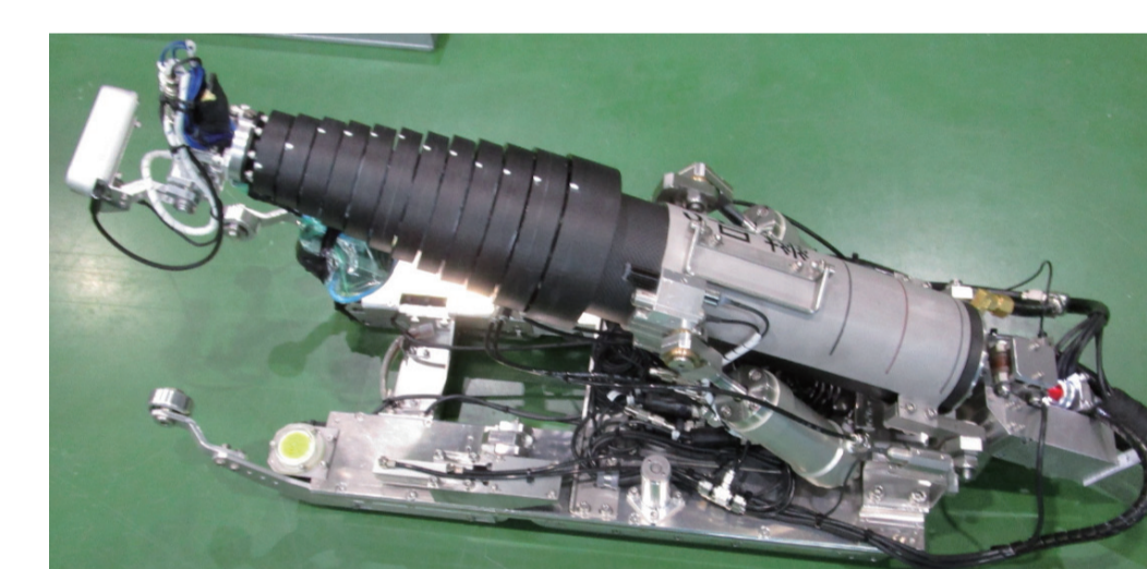
【2台目】調査装置の外観 (ロッド収納、点群データセンサ搭載)
