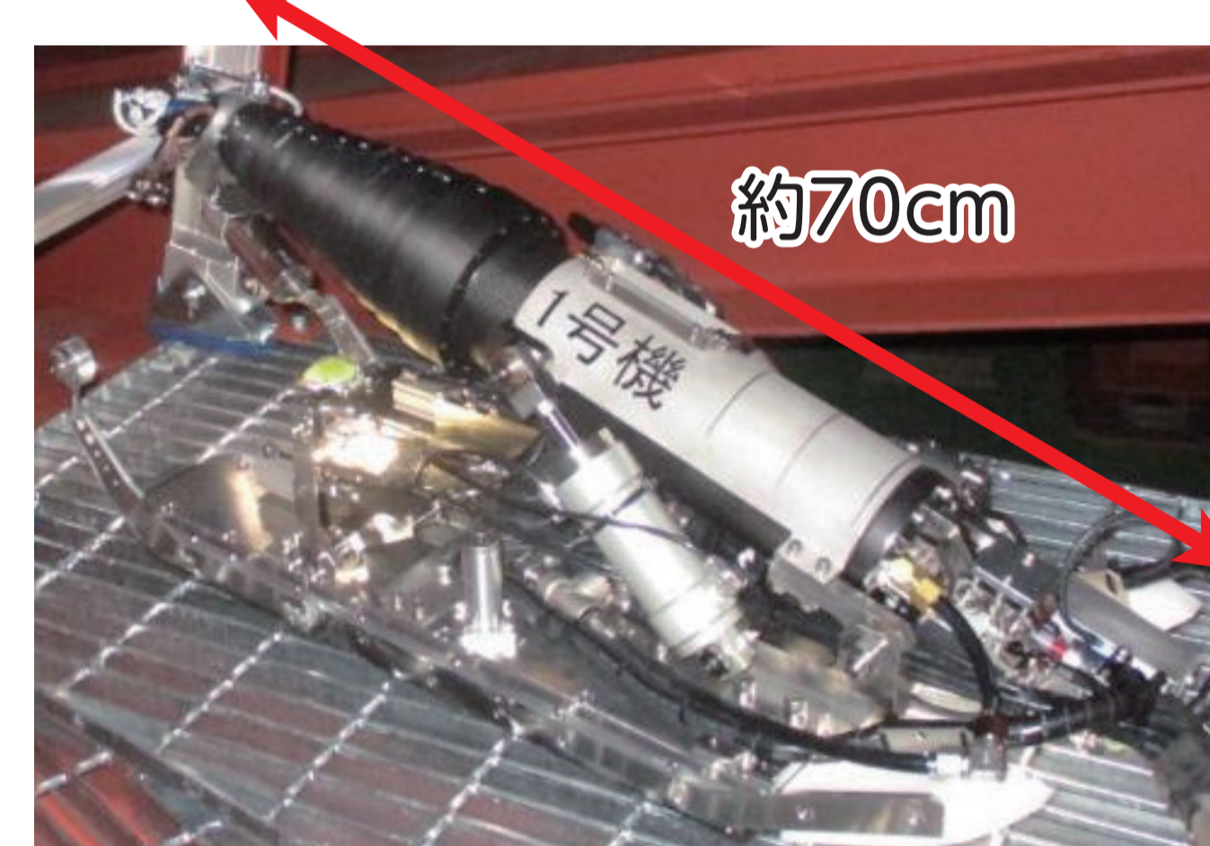
【1台目】調査装置の外観 (ロッド収納、放射線センサ搭載)
