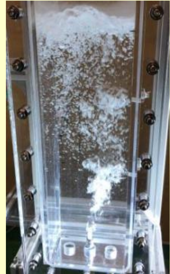
気液界面における微粒子移行試験の例
