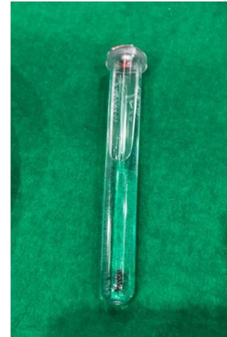
真空容器方式による模擬粒子(1.0mm鉛玉)採取
