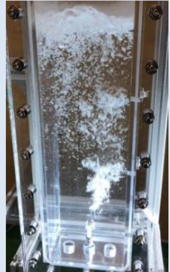
気液界面における微粒子移行試験の例
