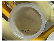
硝酸溶解(6時間加熱後) 硝酸+フッ酸溶解(18時間加熱後) 溶解結果
