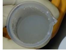
硝酸溶解(6時間加熱後) 硝酸+フッ酸溶解(18時間加熱後) 溶解結果
