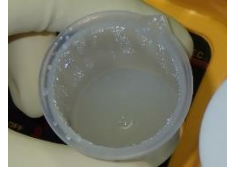
硝酸溶解(6時間加熱後) 硝酸+フッ酸溶解(18時間加熱後) 溶解結果
