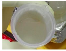
硝酸溶解(6時間加熱後) 硝酸+フッ酸溶解(18時間加熱後) 溶解結果
