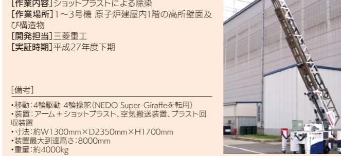
写真は吸引・プラスト作業タイプ
