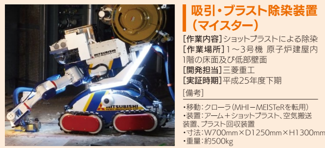
写真は吸引・プラスト作業タイプ
