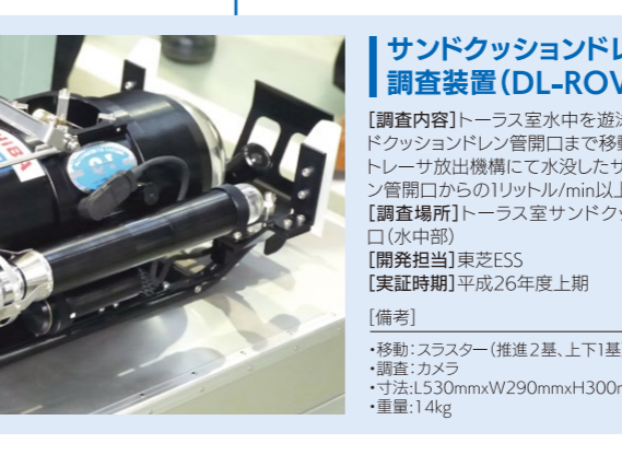
写真は吸引・プラスト作業タイプ
