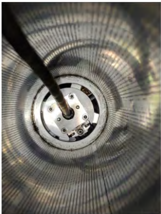
試験後の1段目パイプの内部
