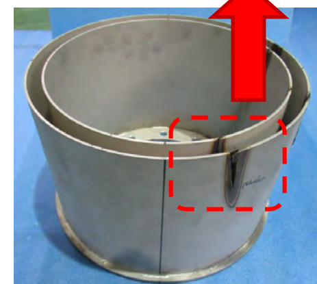
気水分離器部分模擬体切断試験結果(レーザ)
