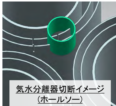
ホールソー 鉛直方向切断 (外筒+中間筒切断)
