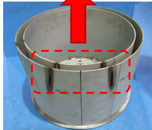
気水分離器部分模擬体切断試験結果(レーザ)
