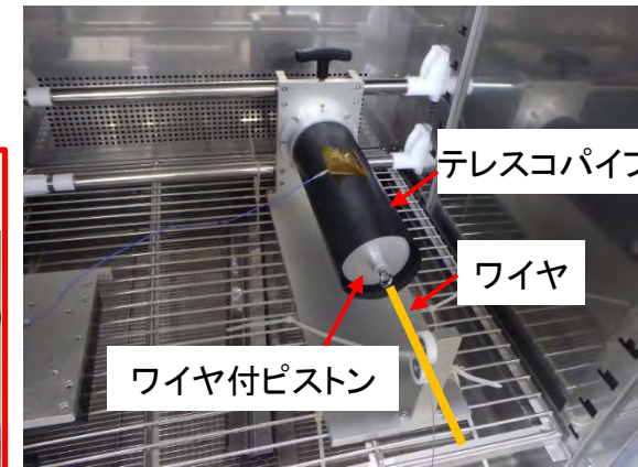
試験架台を恒温槽内に固定した様子
