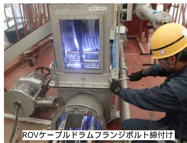
ROVケーブルドラム範雄/据え付けトレーニング状況
