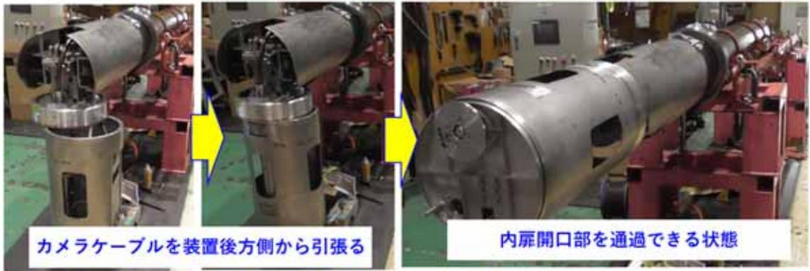
ギア空回り時の内扉開口部通過状態への変形動作確認状況
