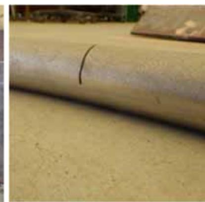
模擬PLR計装配管の試験後外観
