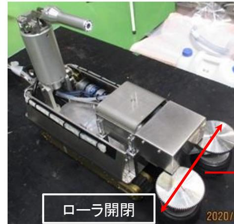
図30 ケーブル送り装置 試作機
