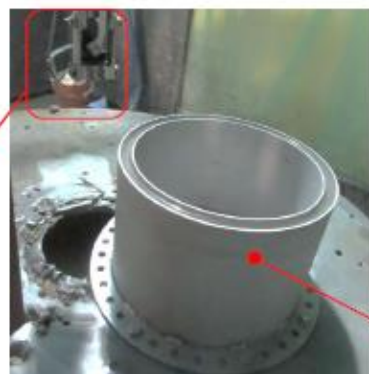
加工前の気水分離器模擬体
