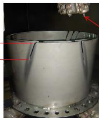
加工後の気水分離器模擬体
