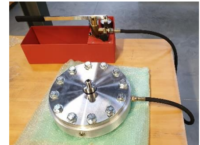
図3 閉止予備試験の状況
