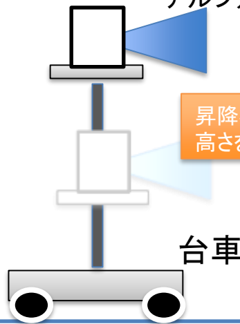
図1 昇降、パン・チルト機能を使ったアルファカメラの測定イメージ
