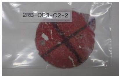
図2 分析試料(外壁防水材)の外観
