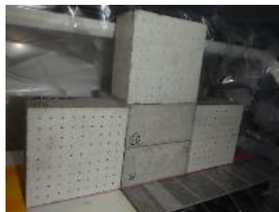
図2 分布測定用のタイリングの状況
