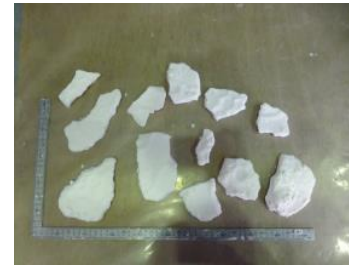
図2 脱水物の外観
