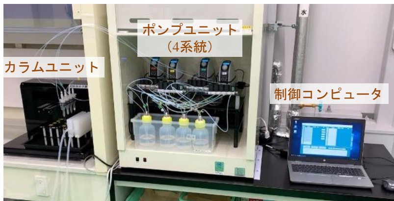
図1 自動固相抽出装置を中核とする自動化システム (イオン交換および固相抽出の部分)
