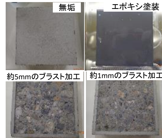
図3 各コンクリートの外観
