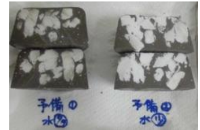
図3 脱水物をそのまま混練した状況
