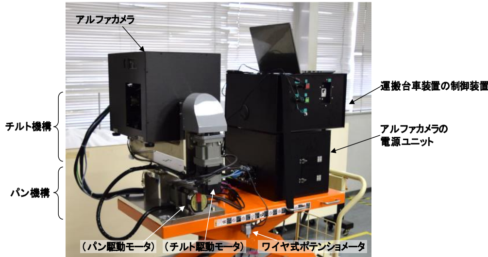
図1 パン・チルト機構の外観
