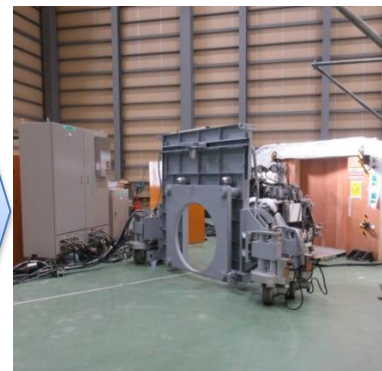
① 追設遮蔽板の仮置きから据付初期位置への移動
