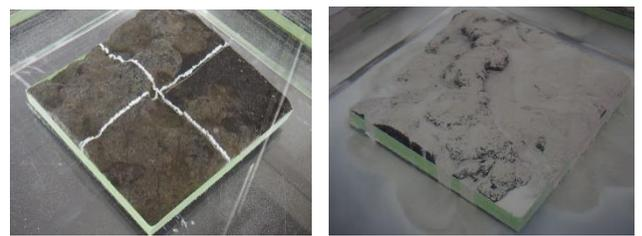
図6 凹凸の大きな燃料デブリに液体→固化タイプの吸収材を使用
