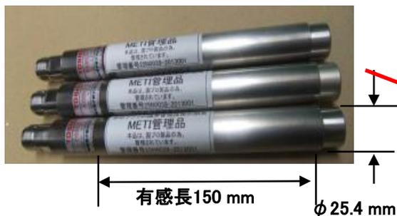
図2 B-10比例計数管型 中性子検出器
