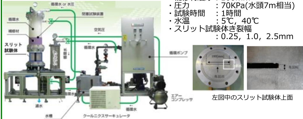
止水性能確認試験装置 (PCV補修技術PJで使用した装置にて実施)
