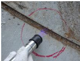
S/Cシェルとの境界部のUV照射確認，反応なし
