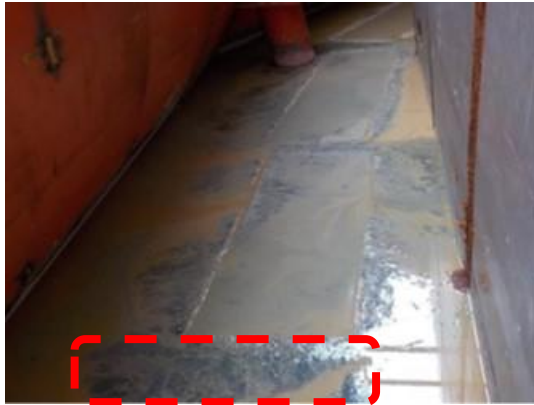
補修材表面上に燃料デブリ模擬粉(黒色)が堆積
