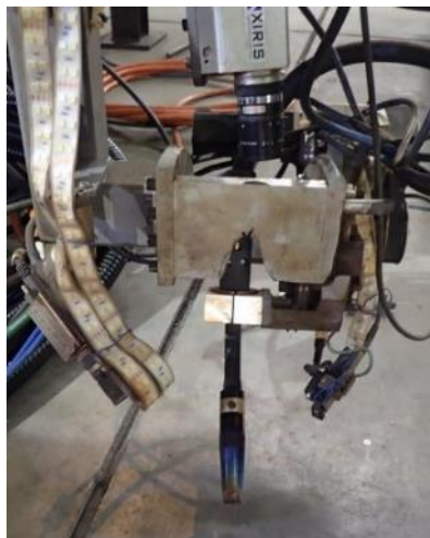
S/C継手溶接装置 (トーチ部拡大)
