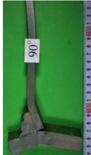
継手引張試験後の試験片外観
