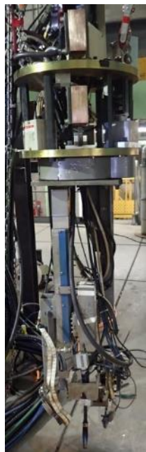
S/C継手溶接装置 (全体外観)
