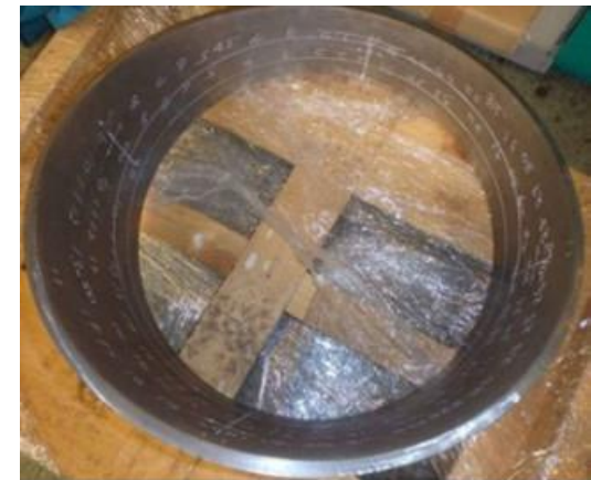
延長配管下端部(マーキング後)
