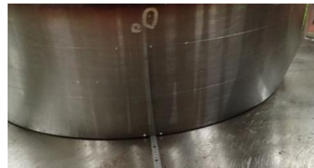
延長配管-S/C表面間隙間量
