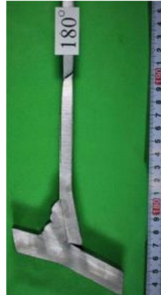
継手引張試験後の試験片外観
