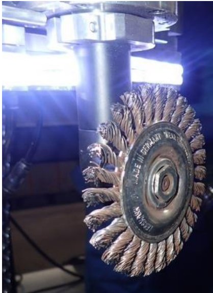
溶接ビード処理装置 (バフツール部拡大)
