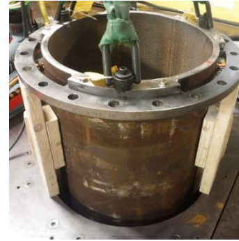
延長配管の仮設支持材での仮固定(No.0)
