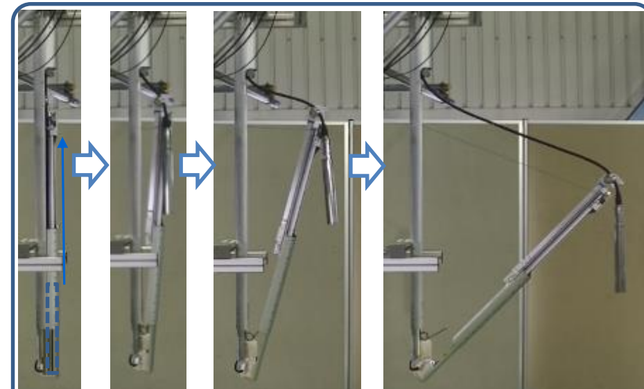
調査装置Cの吊り下げシーケンス動作
