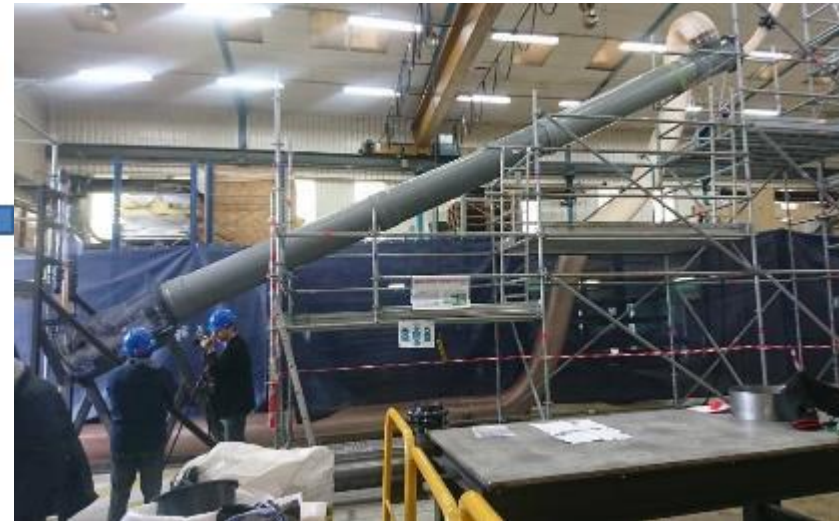
処理水回収試験用装置
