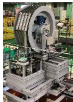
炉内構造物加工アクセス装置
