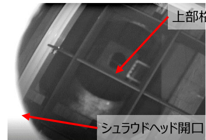
シユラウドヘッド開口通過時の 調査装置映像 (調査装置B3)
