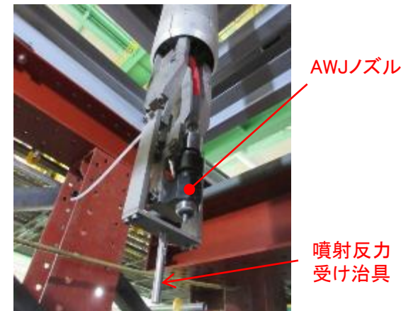
シュラウドヘッド加工用噴射反力受け治具
