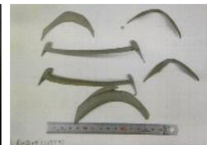
気水分離器内に落下した加工片(例)
