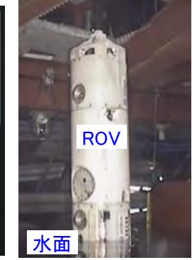
ROV吊り下ろし
