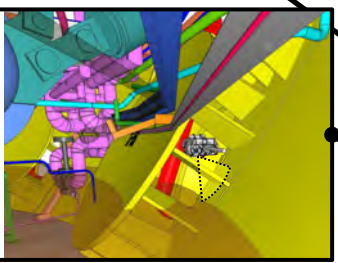
②-4 ベント管への堆積物流出状況確認 (パンチルトカメラ)
