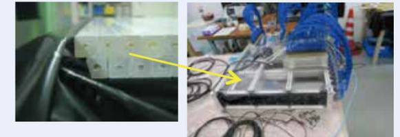
a) 2層化したシンチレータ面 b) 組み立てられた小型の検出器
