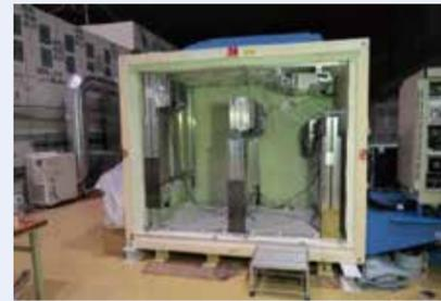
図1 1号機の測定に使用した透過法測定装置
