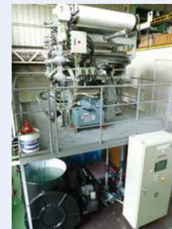
図2 ALPSスラリーの脱水処理を検討するための加圧ろ過試験装置
