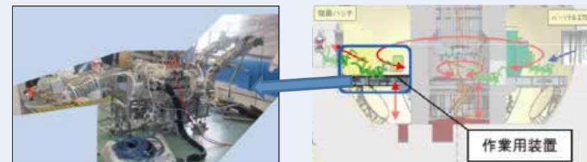
図6 遠隔作業用柔構造アームの実使用イメージ
