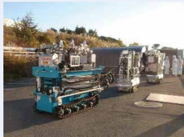
写真1 高所除染装置と低所除染装置の組合せ試験の状況
