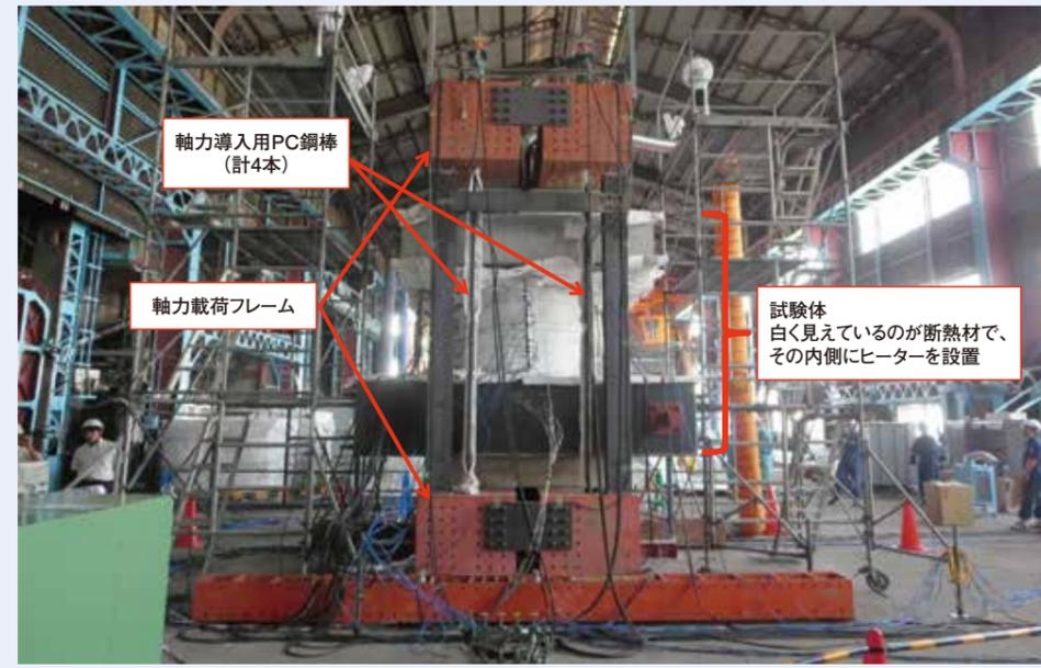
図3 RPVペDESTAL耐力評価試験 (載荷フレーム設置状況)
