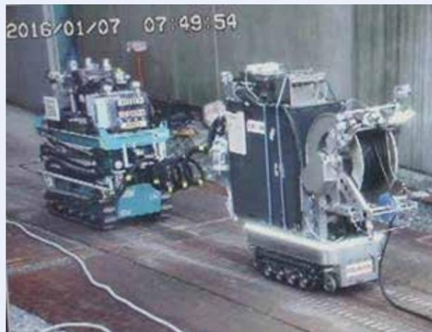
写真2 高所線量率調査の状況(左:高所除染装置、右:低所除染装置の2台構成)
