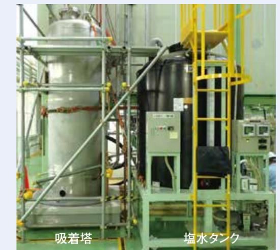
図3 吸着など各種の試験に用いる実規模吸着塔の外観
