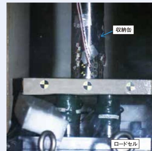
図3 収納缶の鉛直落下試験例
