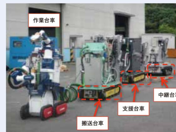
図3 上部階用除染装置(吸引・ブラスト装置を搭載した場合)
