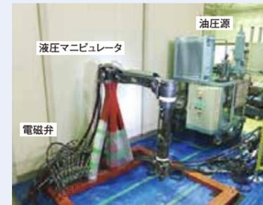
図3 液圧マニピュレータに関する試験装置の外観写真
