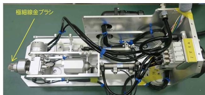
図3 少量サンプル回収装置(極細線金ブラシ方式)
