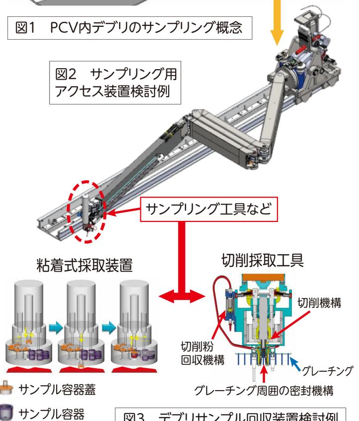
図3 デブリサンプル回収装置検討例
