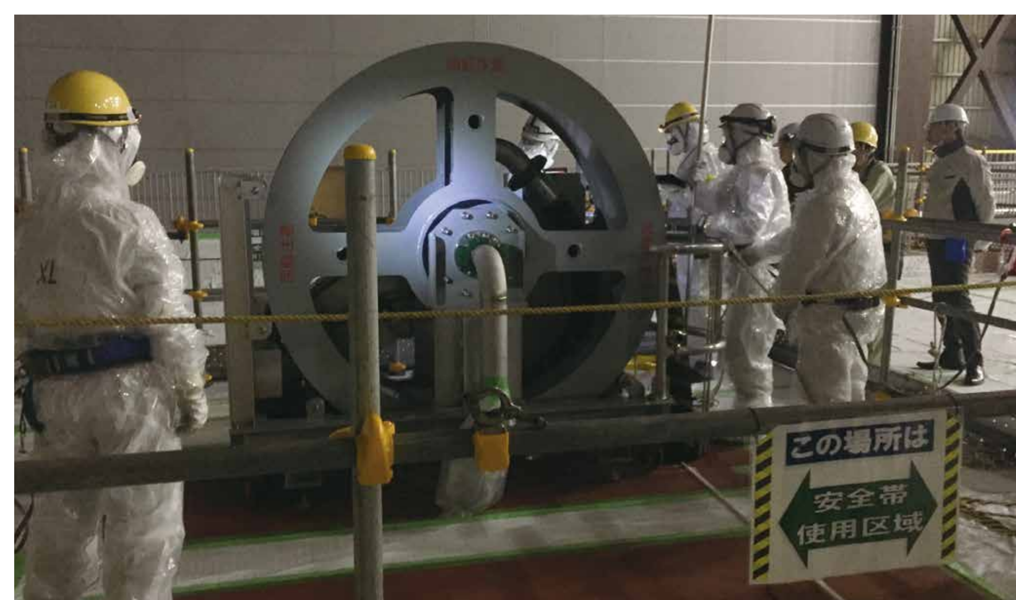
左写真: 実機の作業環境の模擬・作業装備を装着し所定の作業を所定の時間内に完了できるかを試験
