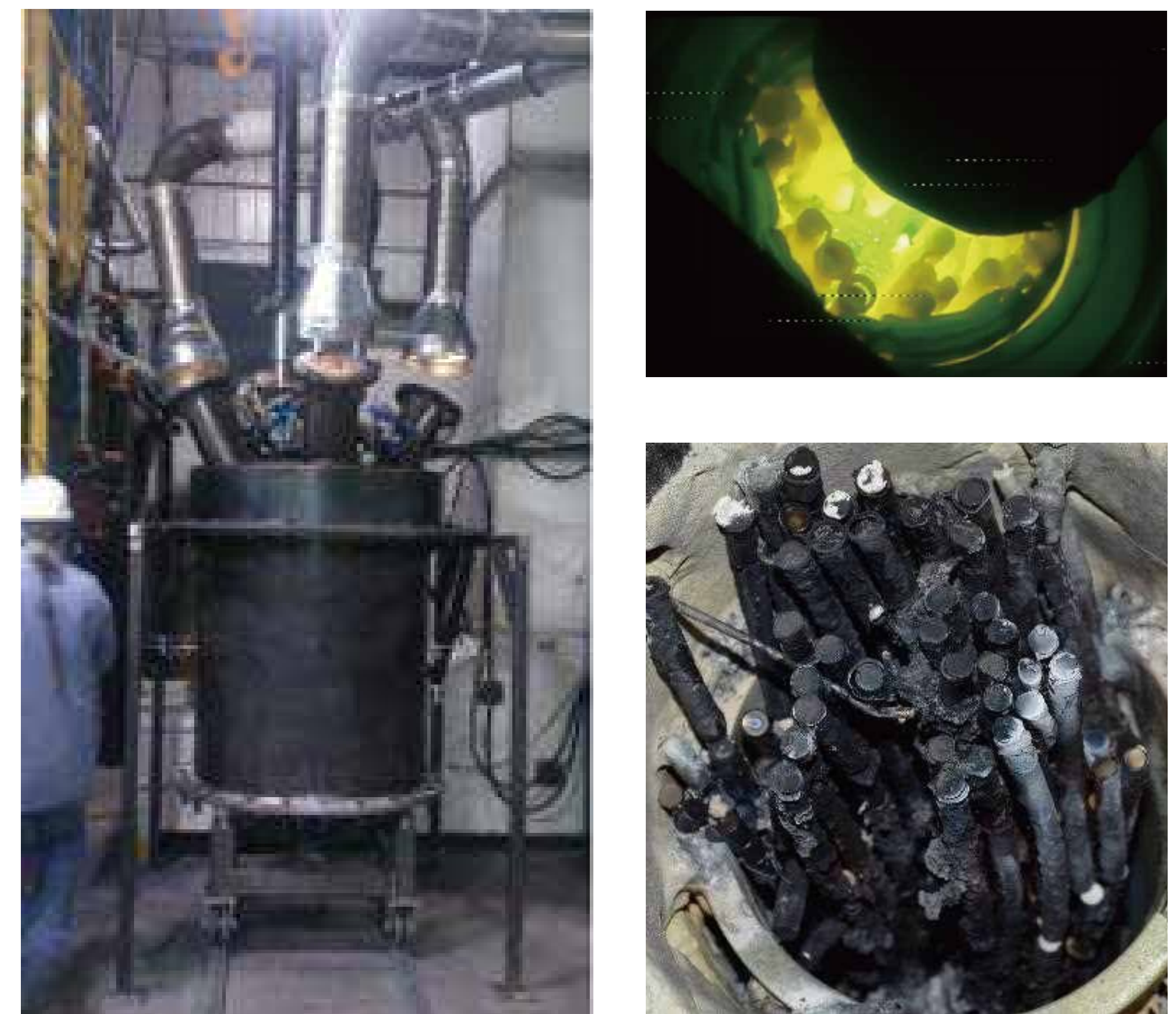
模擬燃料集合体破損試験 (試験装置、加熱状況、試験後の試験体)
