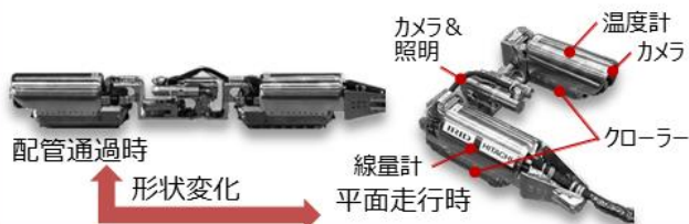
形状変化型ロボット(1号機)
