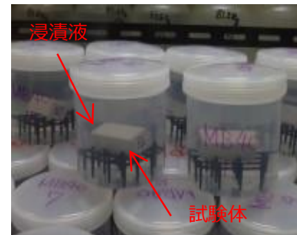
図2 非平衡溶出試験の浸漬状況
