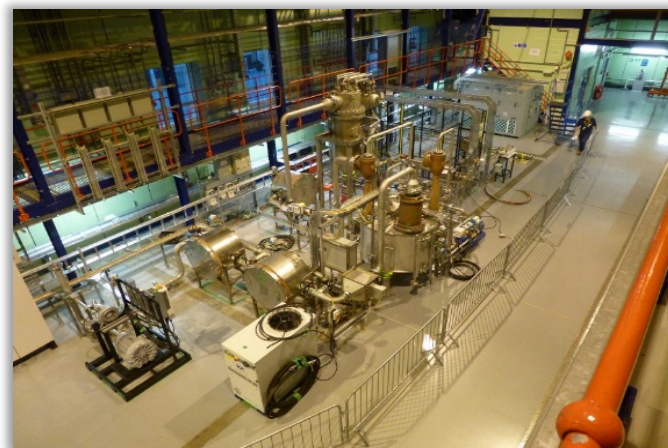
(1)伊賀市のGeoMelt ICV施設(有害廃棄物をガラス固化) (2)セラフィールドのGeoMelt ICV施設(放射性廃棄物をガラス固化)
