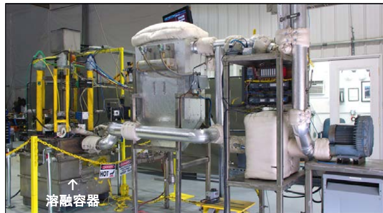
図1 GeoMelt ICV工学規模試験設備
