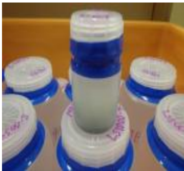
図1 平衡溶出試験の浸漬状況
