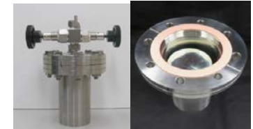
図2 水素ガス発生量評価のために作成した治具
