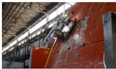
S/C内水位をS/C外面より超音波で測定する
