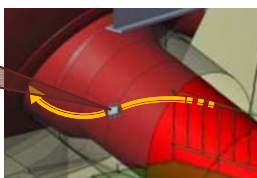
ベント管上を移動し、PCV接合部の漏えいを調査
