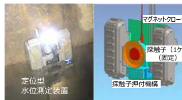
S/C内水位をS/C外面より超音波で測定する
