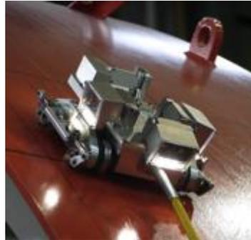
S/C内水位をS/C外面より超音波で測定する
