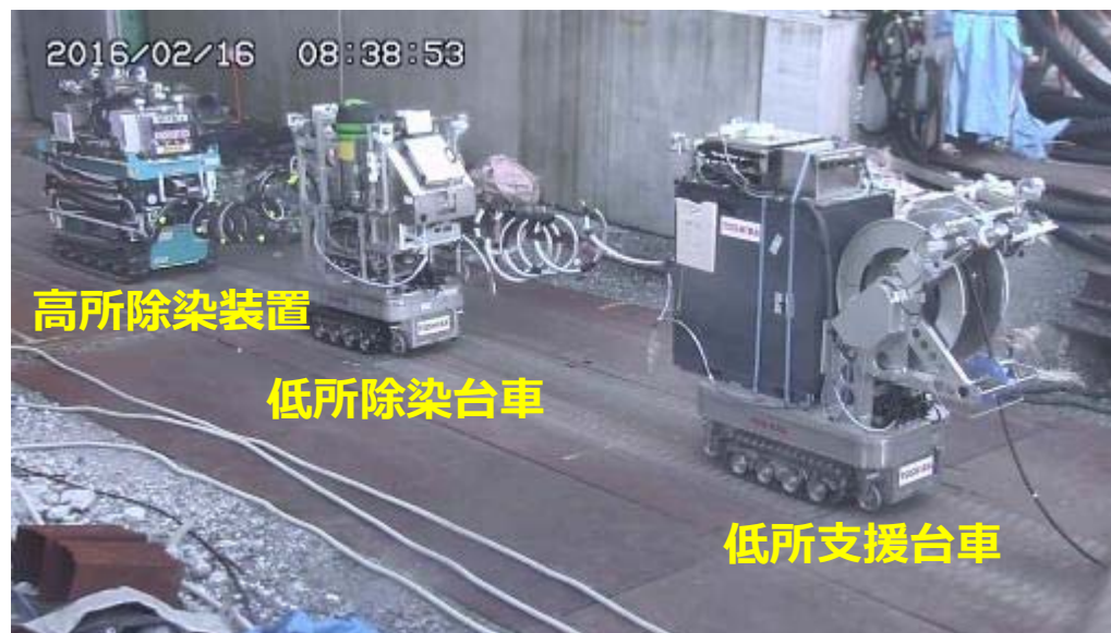
3号機R/B内への進入風景
