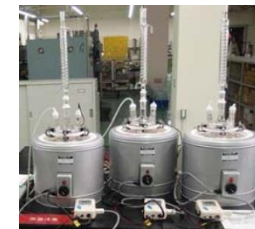
長時間腐食試験
