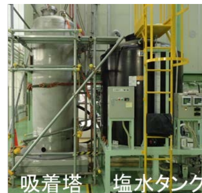
図1 吸着など各種の試験に用いる実規模吸着塔の外観
