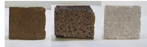
SIAL固化試料(模擬廃棄物40%充填)
