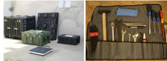
写真-2 <ASTM-E2592-07> 搬送用運搬、展開性等に関するSTM 搬送時梱包の体積・重量や、ロボットセット アップに要する時間、ロボットメンテナンス用 ツール等の確認方法。梱包部材だけで現場 で10日間稼働できることが条件。
