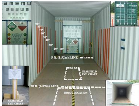
写真-1 <ASTM-E2566-08> ビデオシステムの視力及び視野 決定のためのSTM
