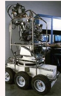
遠隔作業ロボット(RWV) 4900kg
