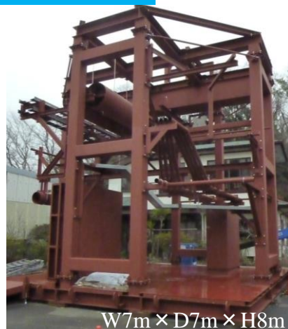
W7m x D7m x H8m 高所構造物モックアップ (試験中は外周に遮光シート設置)
