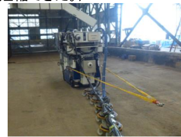
電動ウィンチにより牽引回収する様子
